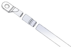
Figura 2-7 Terminal de cobre, tubo termorretráctil y cable de cobre
